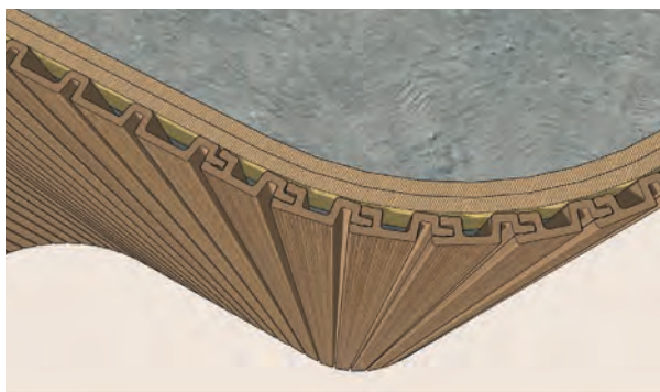
Pose verticale sur mur courbe convexe de rayon 1 mètre mini
