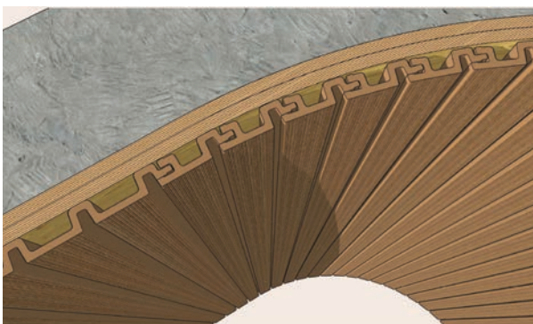
Vertikale Installation auf gewölbten, konkaven Wänden mit Radius von mindestens 1 m
