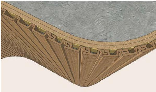
Vertikale Installation auf gewölbter, konvexer Wand mit Mini-Radius von 1 m
