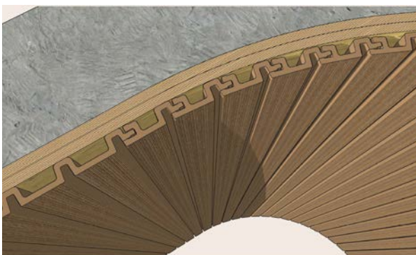
Vertikale Installation auf gewölbter, konkaver Wand mit Mini-Radius von 1 m
