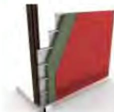
Cladursa se présente sous la forme d'un panneau de laine de verre semi-rigide densifié et rainuré spécialement conçu pour les bardages métalliques. Son rainurage est compatible avec tous les profils de lèvres pour un bon maintien. La pose du procédé, monocouche, est rapide et ne nécessite pas d'écarteurs pour les bardages verticaux.
